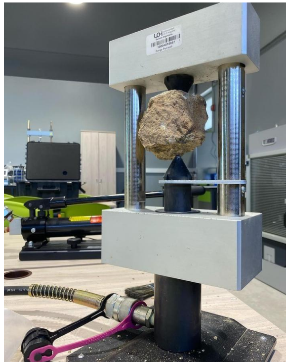
Figura 21. Equipo para ensayos de carga puntual. Fotografía tomada por Alejandra Serey.
