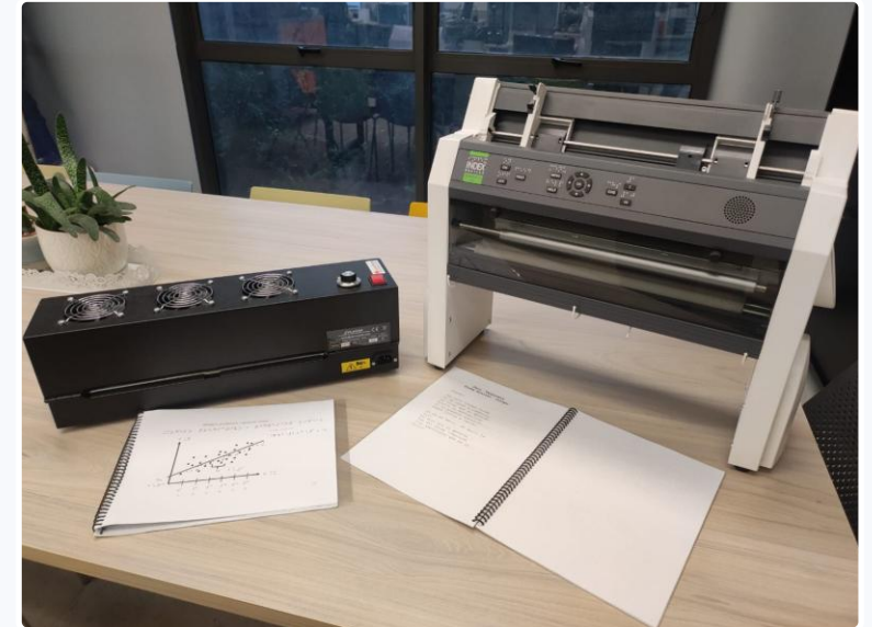
Horno fuser e impresora braille, incorporados para la adaptación de textos y gráficos
