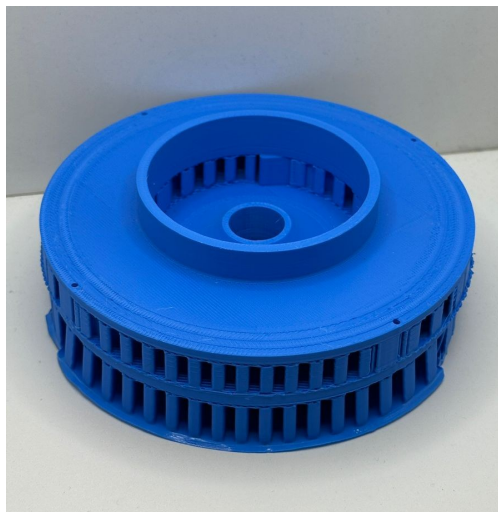
Figura 2.5: Impulsor impreso en 3D sin post-procesado.
