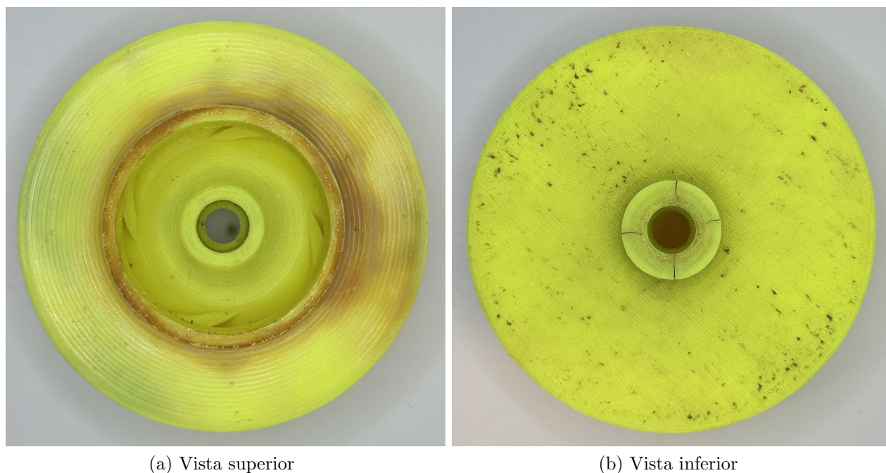
Figura A.2: Segunda versión de impulsor impreso en 3D.
