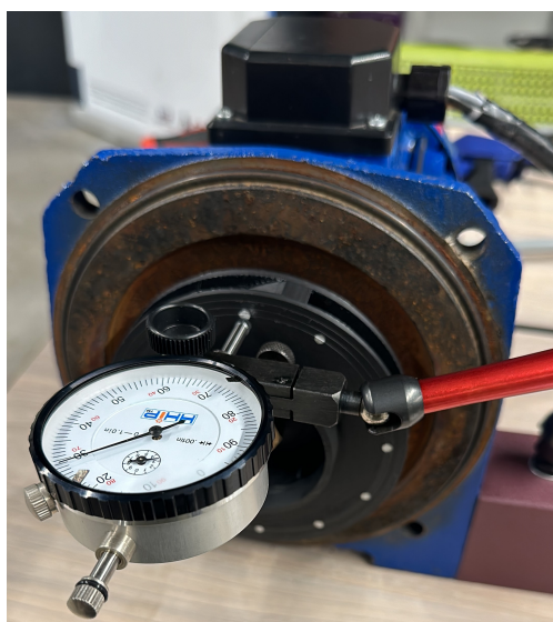
Figura 2.7: Montaje del reloj comparador.
