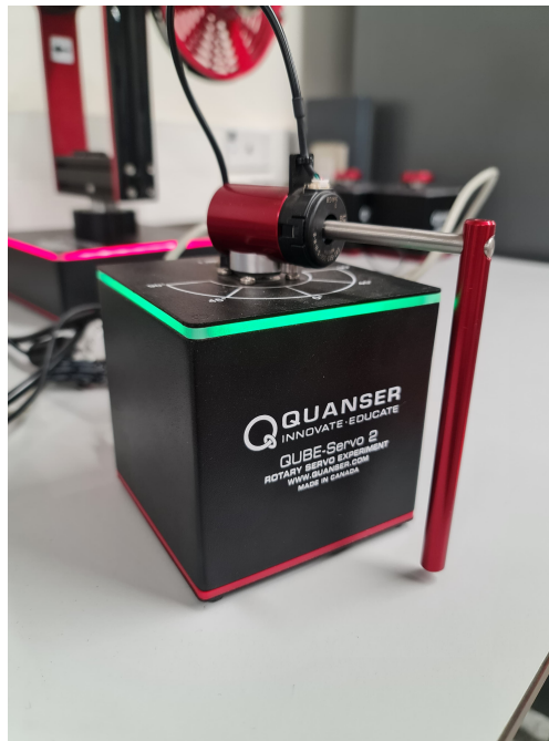
Figura 11: Péndulo invertido rotatorio Qube Servo 2 de Quanser.
