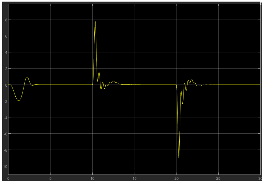
Figura 32: Ángulo del péndulo con controlador Adaptativo.
