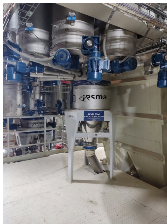
Figura 6: Tolva de pesaje Jesma Jesbatch-30 (NANO-Ingredientes, Medicados 1 y Medicados 2.
