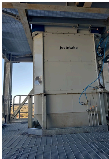
Figura 7: Báscula de flujo Jesma JesIntake 2000.
