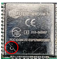
Ilustración 20: Se señala la salida de conexión para la antena de transmisión.
