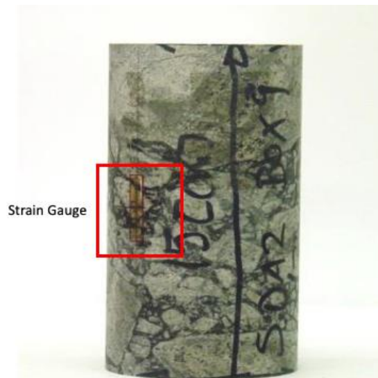
Figura 13: Strain Gauges ubicado en una probeta de ensayo (encerrado en rojo). (Fuente: Informe de Resultados Ensayos Geotécnicos Proyecto Sector Inicio Foot Print Fw, 2010).
