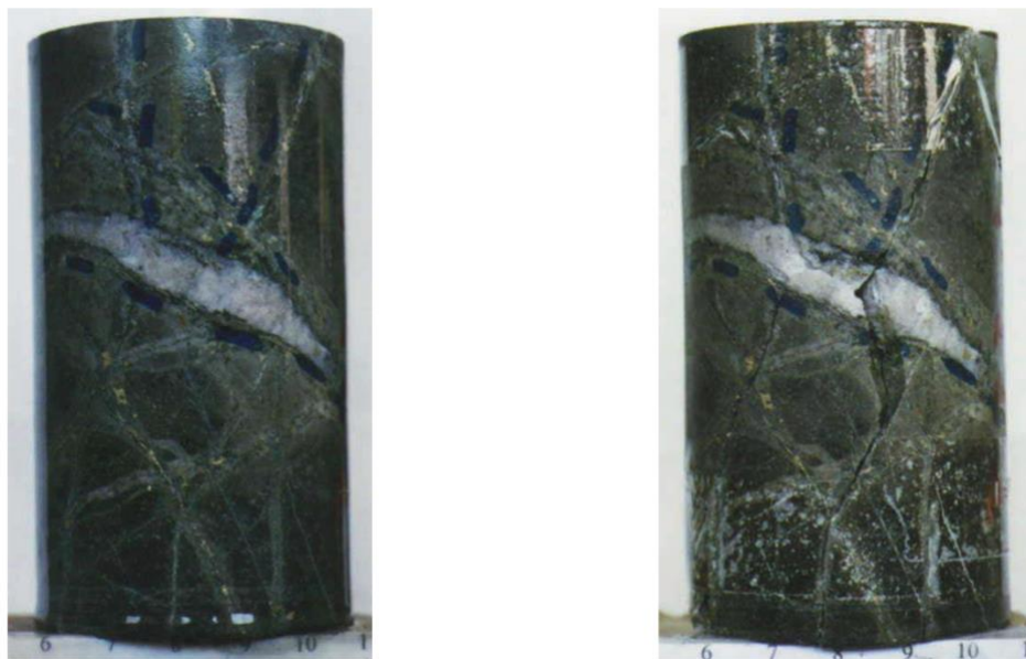
Figura 22: Ejemplo de ruptura “Tipo C”. Correspondiente a Andesita Tte. 4 Fortuna – probetas pre y postensayo. Generación de dos planos de ruptura, ambos por venillas existente. (Capítulo 8, Propiedades del Macizo Rocos. Codelco Chile – División El Teniente).
