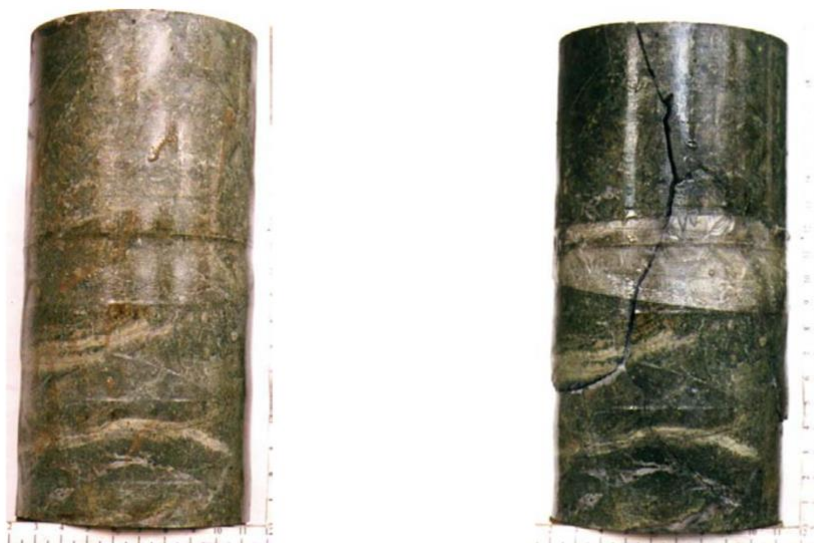
Figura 20: Ejemplo de ruptura "Tipo A". Correspondiente a una brecha marginal clorita - probetas pre y postensayo. Generación de un plano de ruptura por roca (Capítulo 8, Propiedades del Macizo Rocoso. Codelco Chile - División El Teniente).
