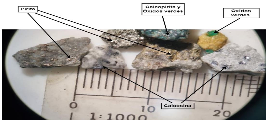
Figura 3.4: Minerales vistos bajo lupa binocular, se observan las propiedades diagnósticas de los minerales Pirita, Calcosina, Calcopirita y Óxidos verdes.
