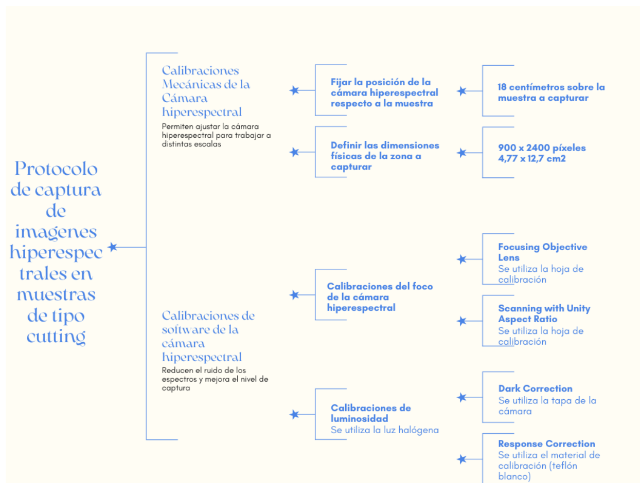
Figura 32: Esquema explicativo del protocolo de captura de imágenes hiperespectrales en muestras de tipo cutting. Figura de elaboración propia.
