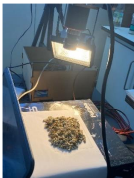
Figura 1. Setup de captura de datos hiperespectrales de muestras de tipo cutting de Codelco–El Teniente. Fotografía tomada por R. González
