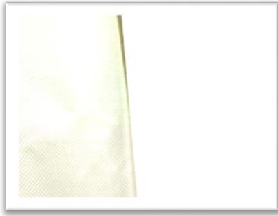
Figura 19. Imagen RGB de la diferencia entre láminas y micas de teflón blanco. A la izquierda se encuentra la lámina de teflón blanco, se observa una pequeña rugosidad y una gran diferencia en el color (RGB), a la derecha la mica de teflón blanco, con una superficie completamente lisa y uniforme. Imagen tomada con el software SpectrononPro.
