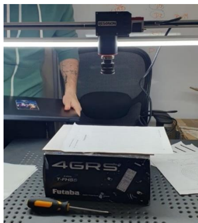
Figura 11. Imagen de la posición y distancia de la cámara Pika L RESONON respecto a las muestras. Fotografía tomada por R. González.
