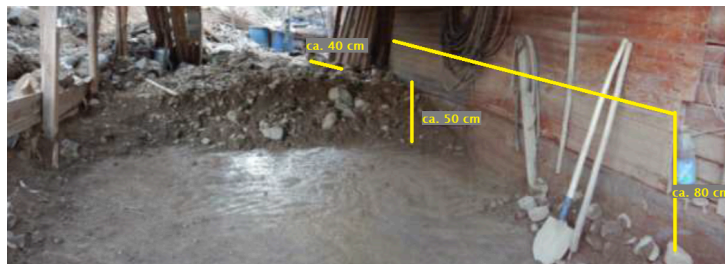
Figura 12. Características del flujo de barro y bloques que afectó a vivienda ubicada en los alrededores de la quebrada 4. El depósito es polimíctico, de ca. 50 cm de potencia, matriz soportada, mal seleccionado, con bloques de hasta 40 cm. El flujo habría alcanzado cerca de 80 cm de altura, manifestado por las marcas de barro en el muro de la vivienda. Extraída de Ramírez C. y Montecino D. (2021)
