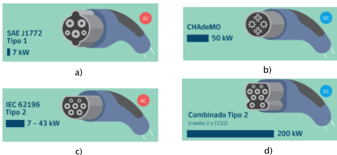
Figura 2: Tipos de conectores. a) SAE J1772, b) CHAdeMO, c) Mennekes, d) CCS (Plataforma de electromovilidad–Modos de carga, s.f.).
