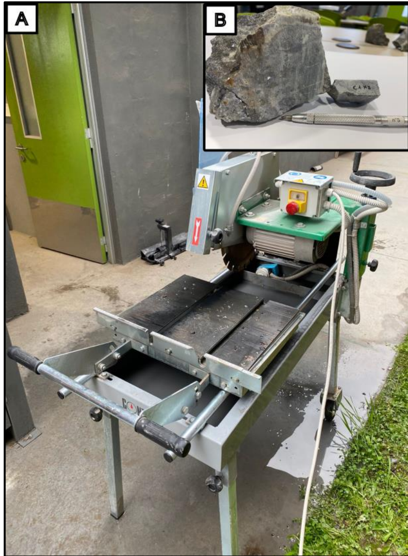
Figura 9: A: Sierra circular del laboratorio de Mecánica de Rocas. B: Muestra de roca cortada y sección tabular.
