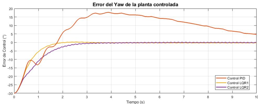
Figura 22: Error de Control del eje Yaw para cada controlador (PID, LQR1, LQR2).
