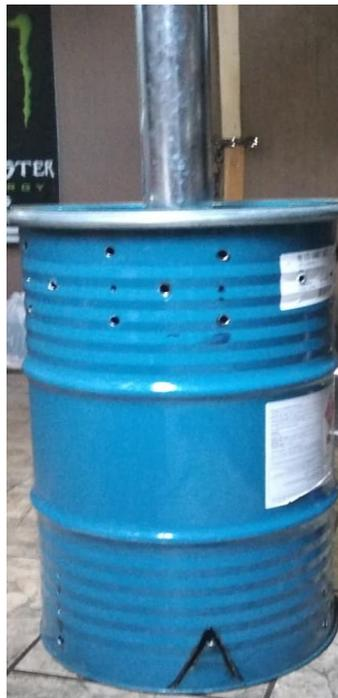
**Figura 6.** Doble horno pirolizador donde se generó el Biochar utilizado
