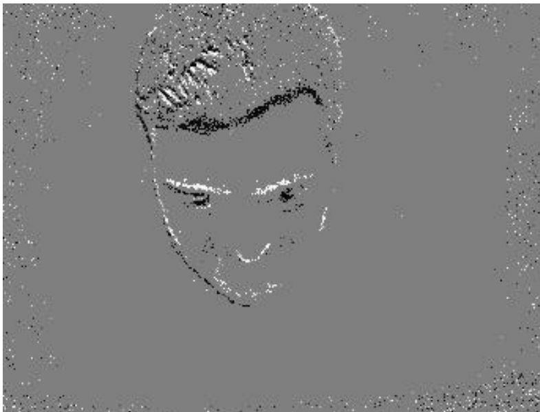
Figura 14. Captura de eventos de replay attack , dentro de un ambiente controlado. Elaboración propia.
