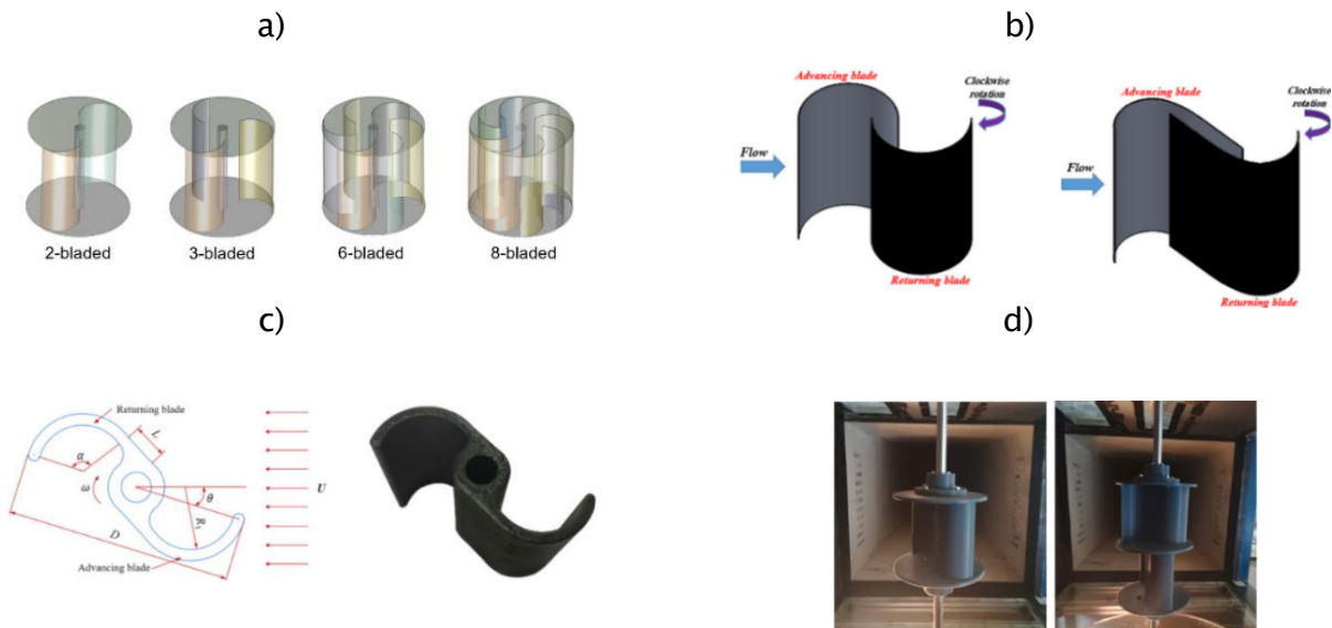
Figura 4. Estudios experimentales en el diseño de turbina Savonius. a) Número de Hélices [14], b) Proporción de Hélices [15], c) Forma de Hélices [16], d) Turbina con dos Niveles [17].
