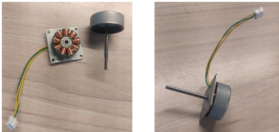
Figura 16. Generador Seleccionado. a) Rotor y Estator Separados, b) Rotor y Estator Ensamblados.
