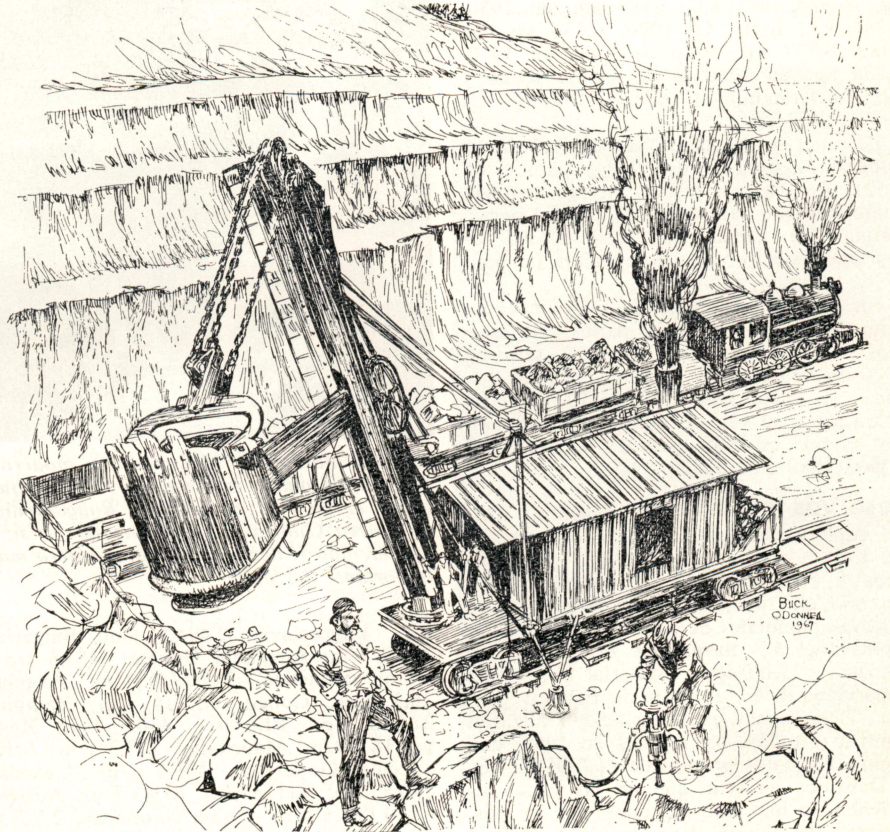
Otro modelo de pala a vapor, usada en 1911, realizando un arduo trabajo similar.
