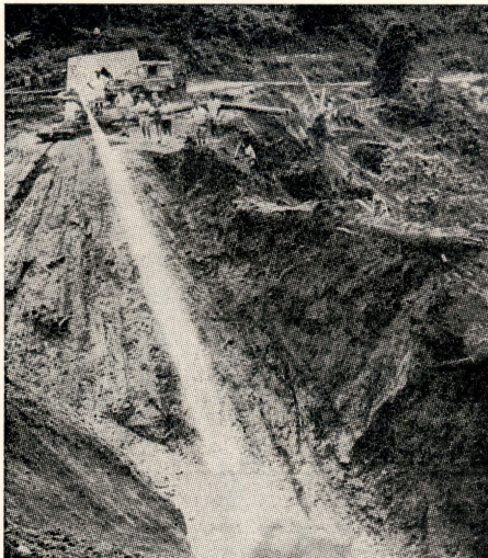
Avance hidráulico: Mediante un moderno sistema hidráulico es lavada la montera que cubre el mineral en la mina Bougainville, de Nueva Guinea. Este yacimiento ha sido considerado el descubrimiento cuprífero más importante del siglo.
