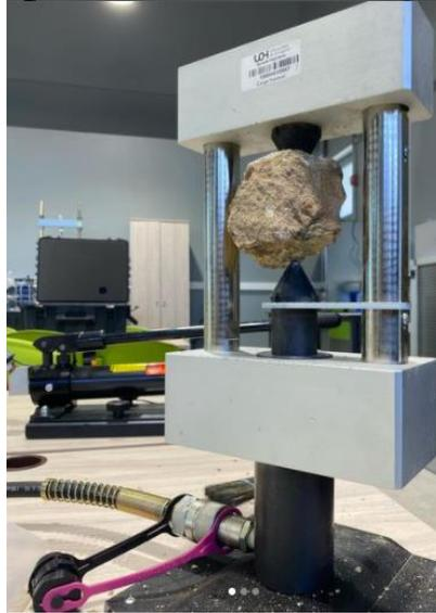
Figura 28: Ensayo de carga puntual. Foto tomada por A. Serey (2021)
