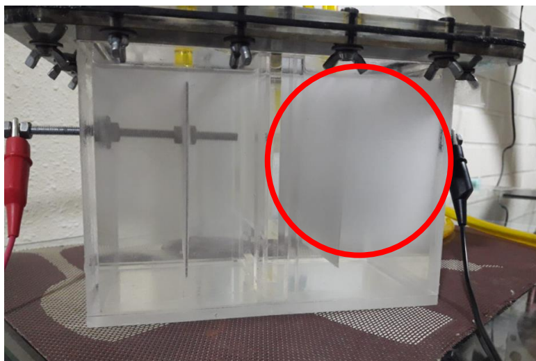
Figura 25: Operación de la celda con barrera divisora de acrílico.
